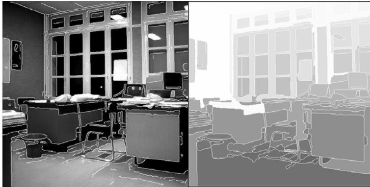
Figure 2.13 - Comparaison entre une détection de contours avec filtre de Deriche (image de gauche) et l'extraction des frontières entre régions (image de droite).
