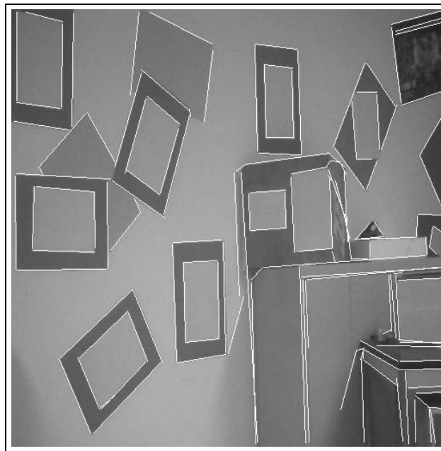
Figure 6.7 - Scène de bureau - Détection et groupement de segments - 144 segments extraits à partir de 54 groupements sur 440 chaînes (note : les discontinuités des segments en blanc sont dues à un défaut d'impression).
